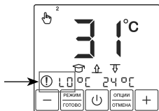
Рис. 17. Обрыв датчика обогрева
