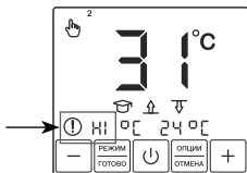
Рис. 18. Замыкание датчика обогрева
