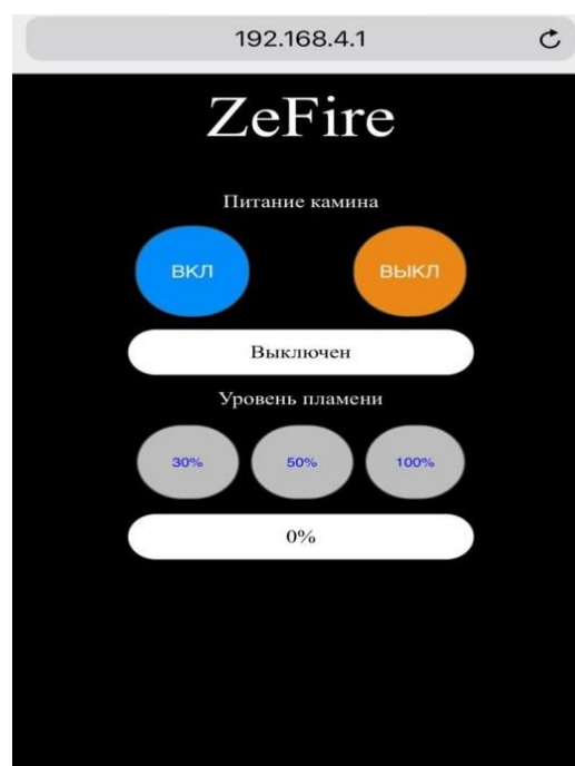
Рис. 2. Панель веб-сервера для управления устройством
