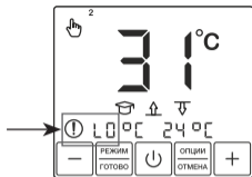
Рис. 17. Обрыв датчика обогрева
